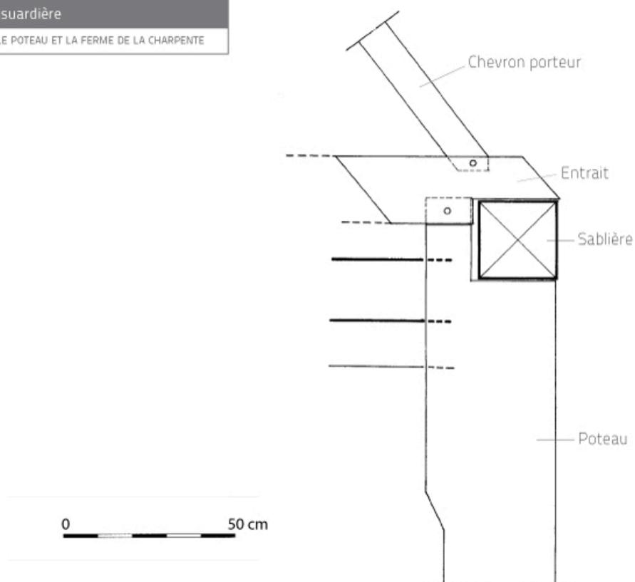
Coupe de l'assemblage entre le poteau et la ferme de la charpente.
