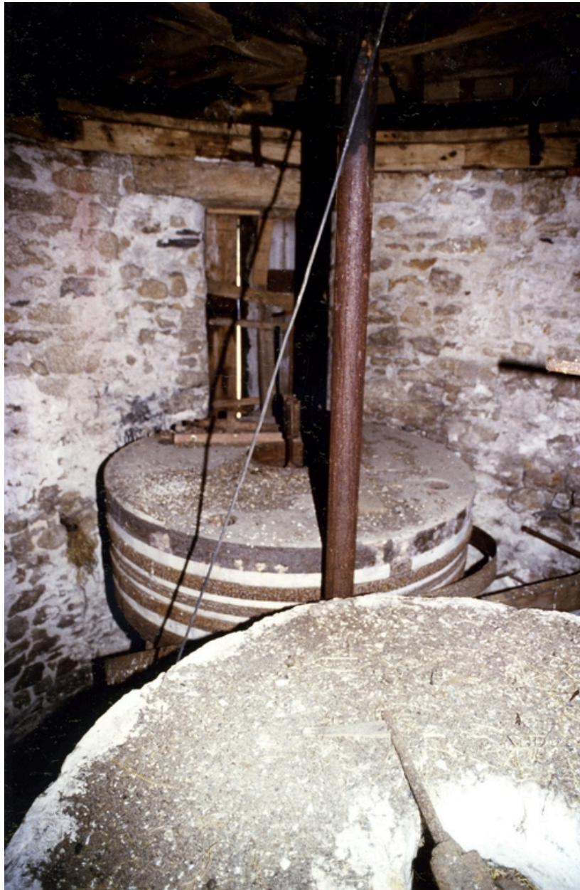
Intérieur de la tour, 1er étage. Les deux paires de meules et le gros-fer descendant vers le palier de distribution. Josick Lancien, septembre 1990.
