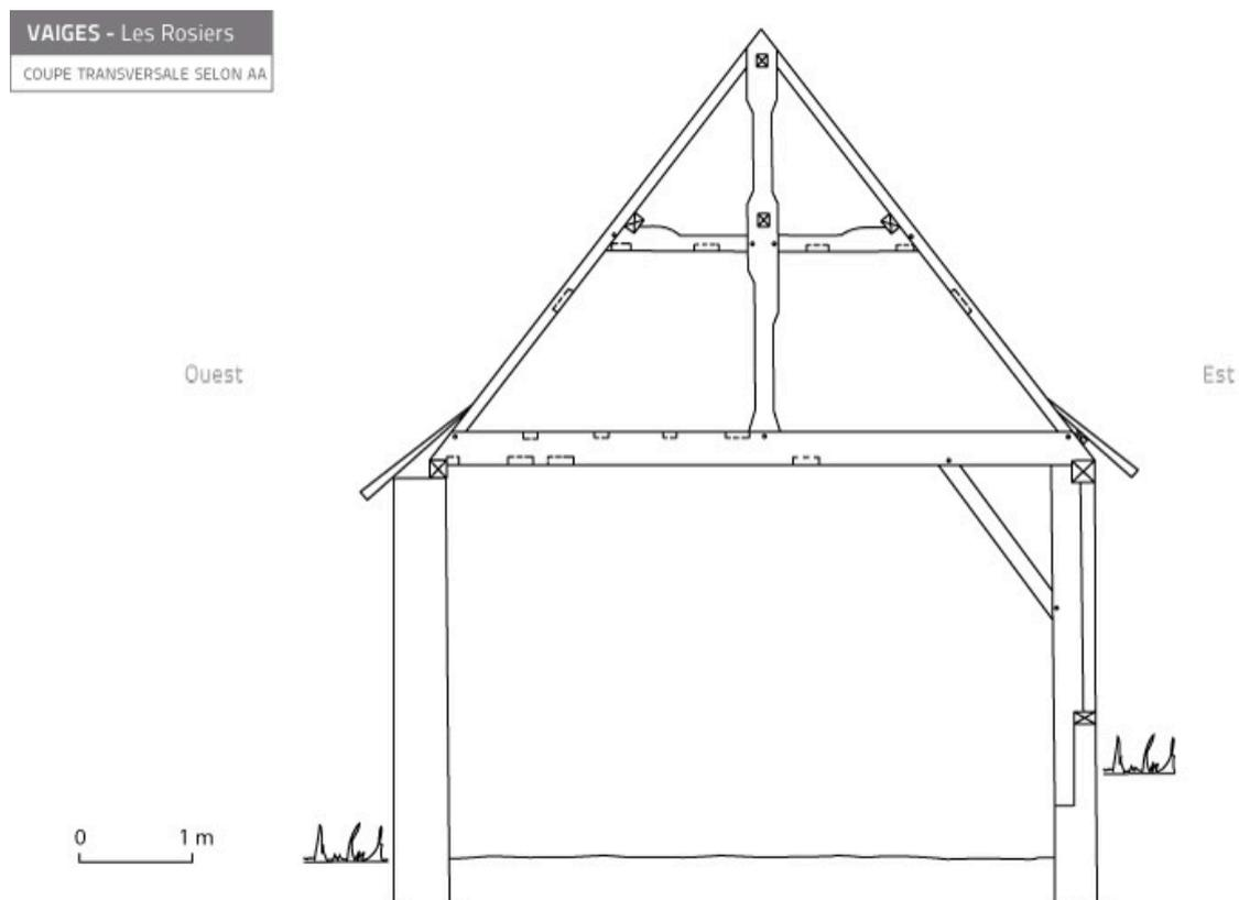
Etable-grange, partie à pan-de-bois : coupe transversale au niveau d'une ferme de charpente.
