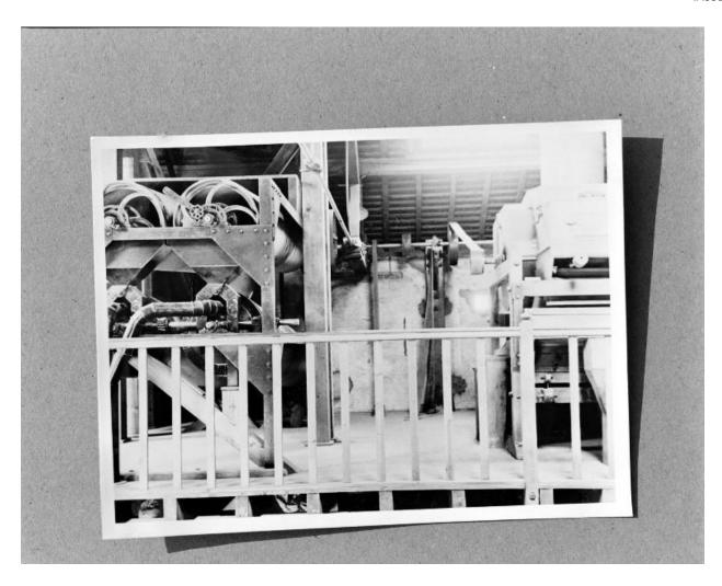
Le bâtiment de stockage, en 1931. Vue intérieure. Le système de nettoyage des grains vu de face. A gauche, la table de nettoyage.
