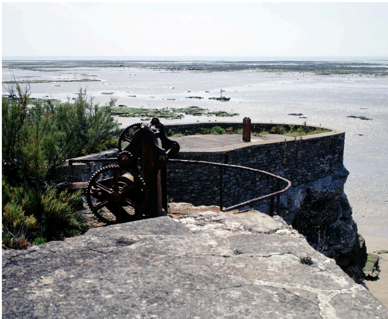
Treuil à engrenages servant à remonter les bateaux.
