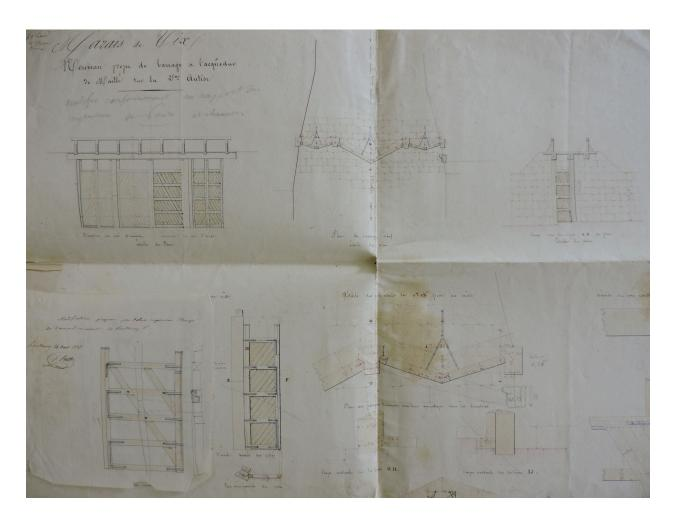
Projet de reconstruction des portes de l'aqueduc de Maillé, 19 février 1844 : élévations, plans, coupes et détails du nouvel ouvrage.
