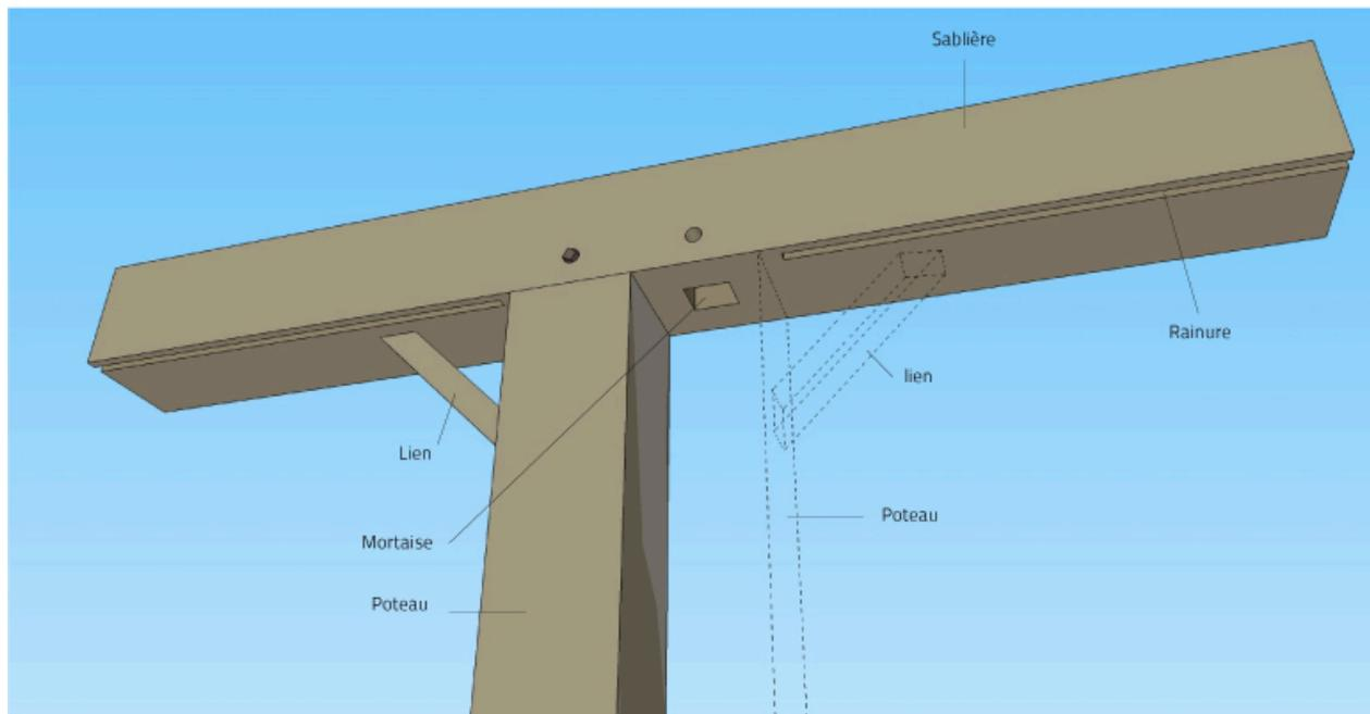
Dessin de détail du pan de bois du mur nord de l'ancien logis : assemblage de poteaux jumelés avec la sablière.
