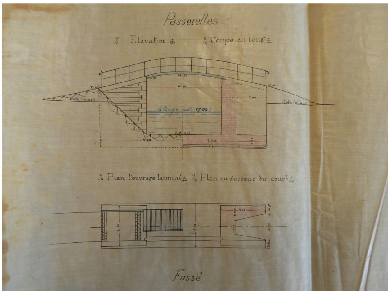
Projet de passerelles aux extrémités du canal à creuser dans les marais de Charouin, 9 novembre 1892 : élévation, plan et coupe.
