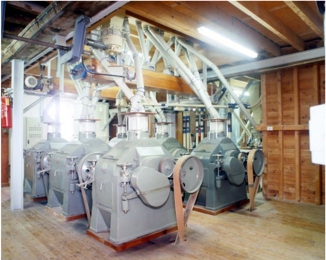
Premier étage, vu du nord-ouest : les broyeurs à cylindres.
