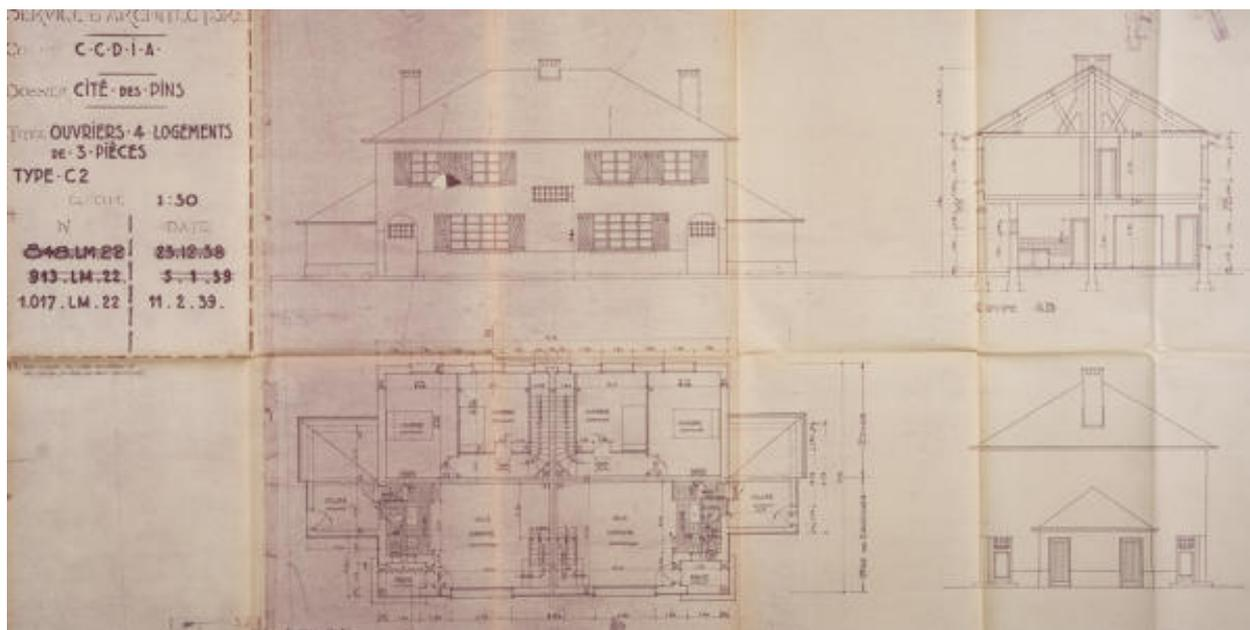
Plan, coupe et élévation pour les pavillons jumeaux.
