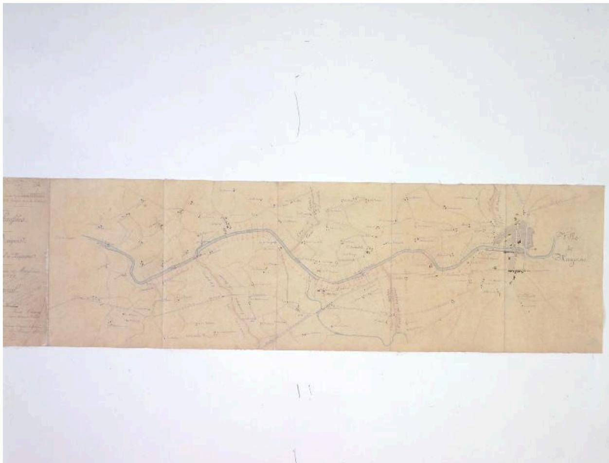
Projet (réalisé) de canalisation de la Mayenne du barrage de Grenoux à Mayenne, 1860. En noir, les anciens barrages (détruits) ; en rouge, les nouveaux barrages à écluse.
