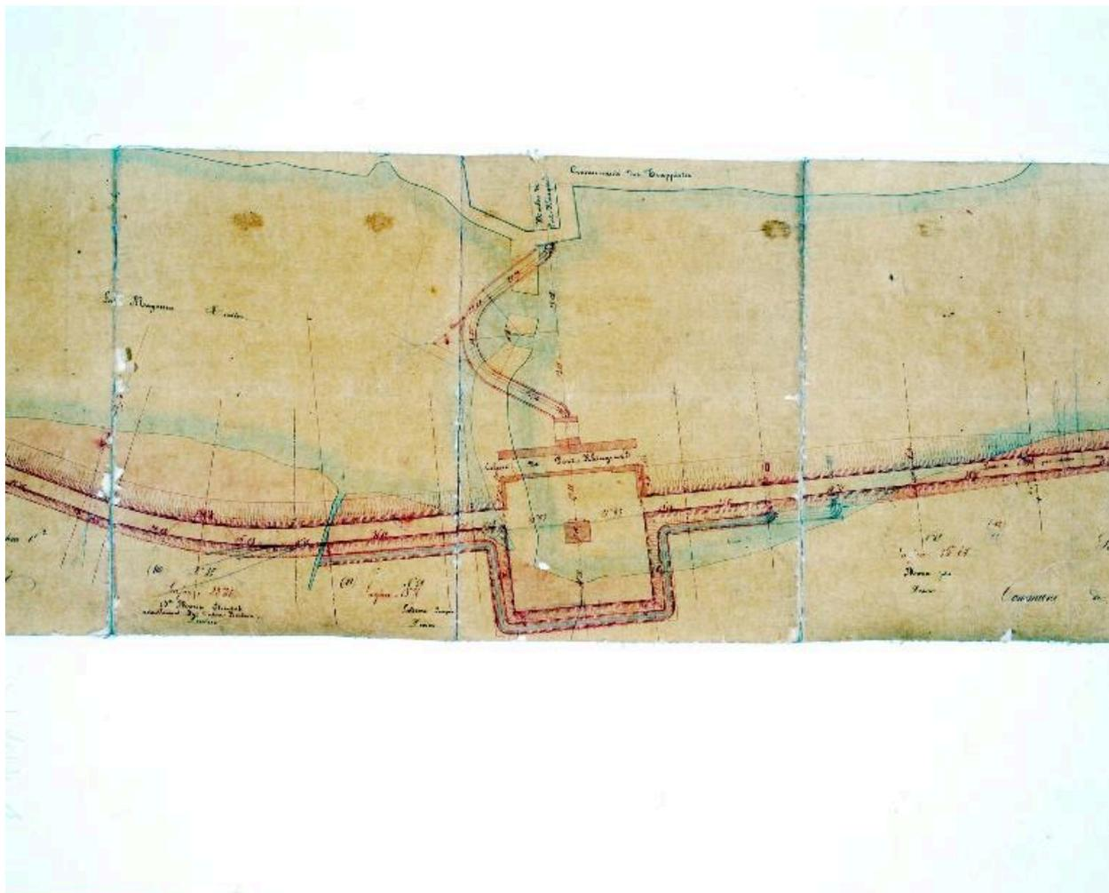
Projet de reconstruction du barrage. Plan d'ensemble : ancien barrage (détruit), nouveau barrage (en construction), moulin à farine.
