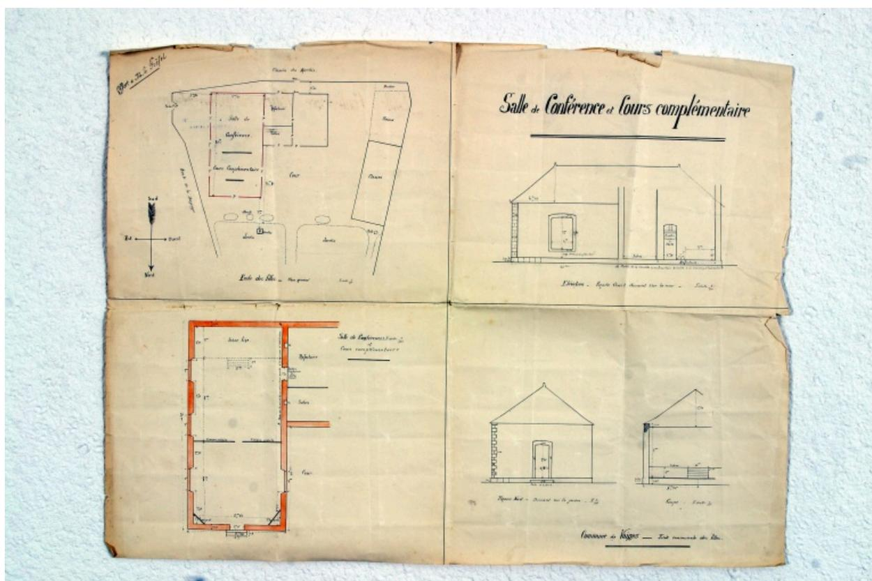
Projet de construction d'une salle de conférence et de cours complémentaire : plan de situation, plan, élévation, coupe, vers 1905.
