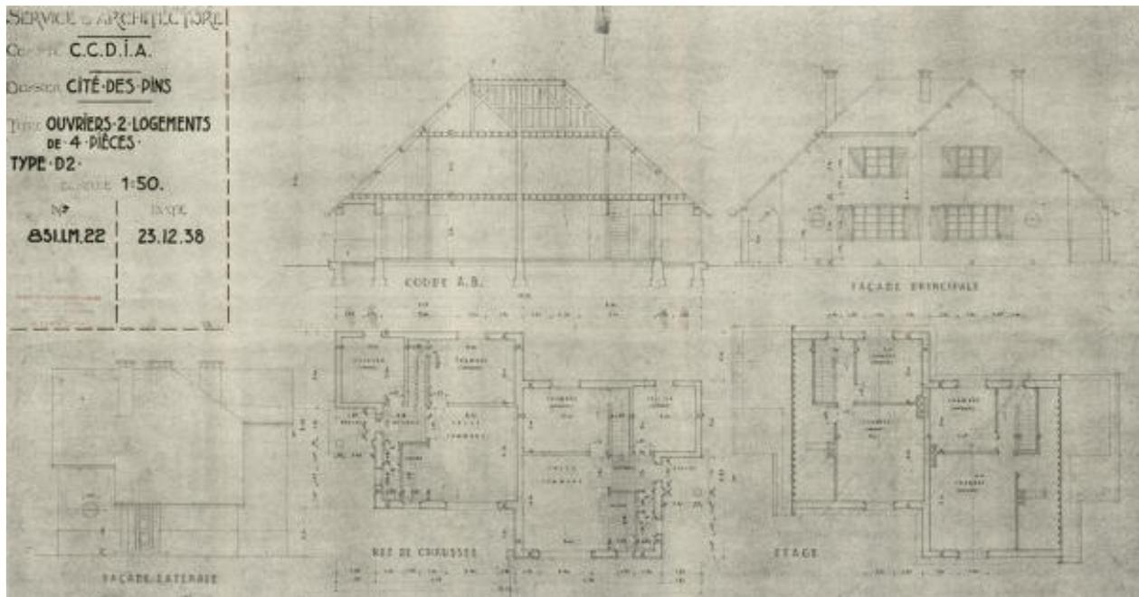
Plan, coupe et élévation des pavillons doubles des ouvriers.
