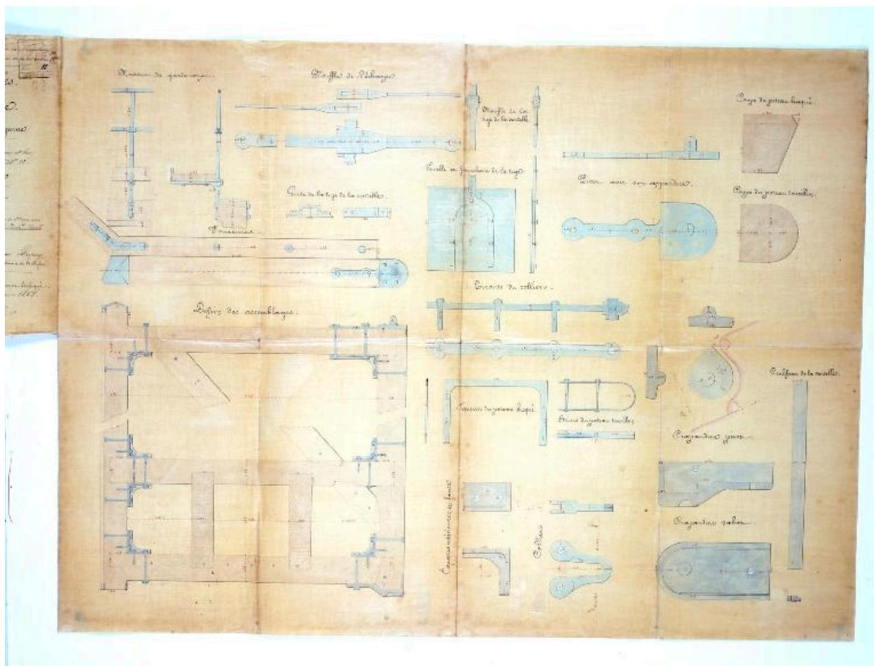
Projet de canalisation de la Mayenne de Bas-Hambert à la Roche. Dessins types de détails des portes d'écluse.
