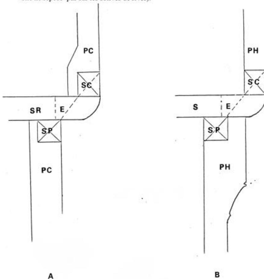
Coupe schématique de l'encorbellement supportant le second étage (A : aux angles, B : autour de la fenêtre).
