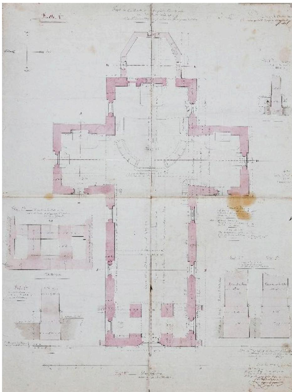
Projet de reconstruction (réalisé) : plan d'ensemble, coupe du mur de l'église, plan des fondations du clocher-porche, coupe du mur de la sacristie.
