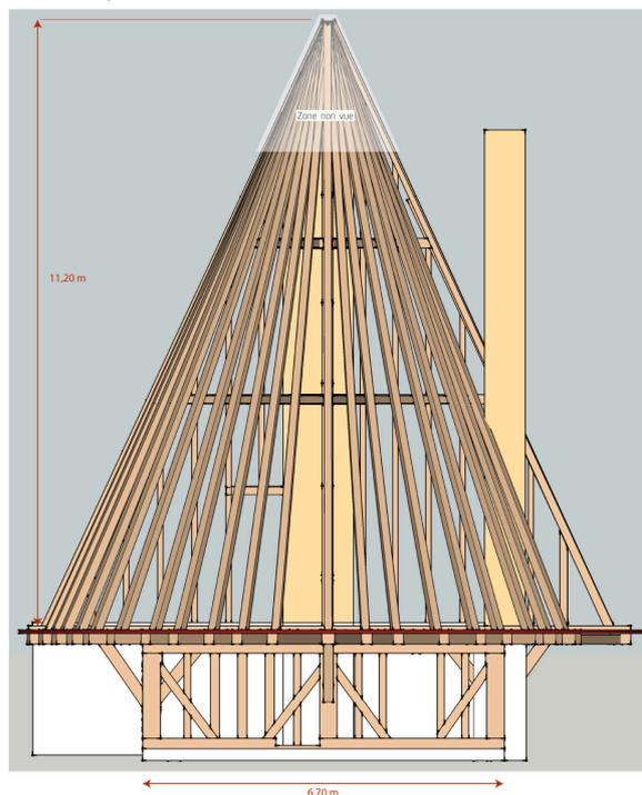
Relève schématique de la charpente du logis : vue générale du corps principal et de la tour nord, élévation depuis le nord de la tour nord et axonométrie de sa structure à colombage.
