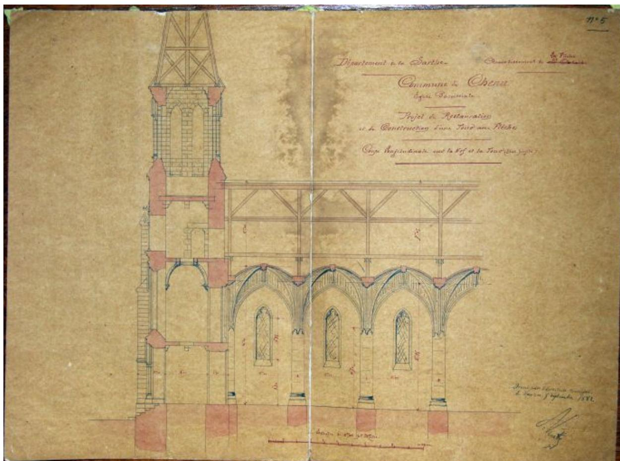
Coupe sur le nouveau clocher et projet de construction d'un vaisseau central sur piliers avec bas-côtés, 1882.
