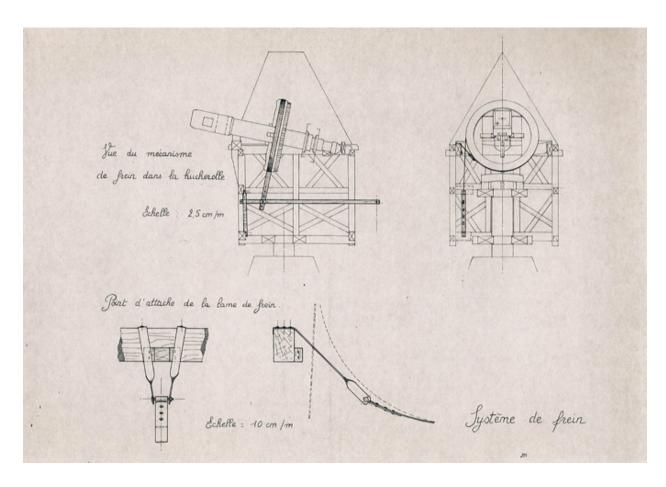
Plan du mécanisme de frein dans la hucherolle (vers 1980).
