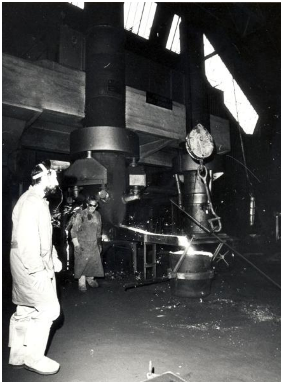
Atelier de fonderie : coulée de la fonte dans le creuset.
