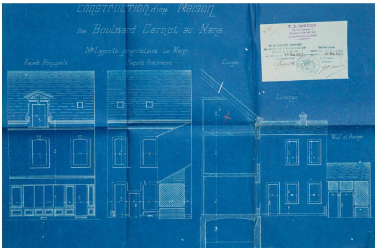
Plans, coupes et élévations pour la construction d'une maison de type mancelle par l'expert géomètre Boutier boulevard Carnot.
