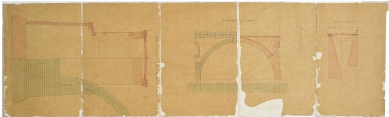
Coupes et élévations d'une pile et d'une arche du pont.
