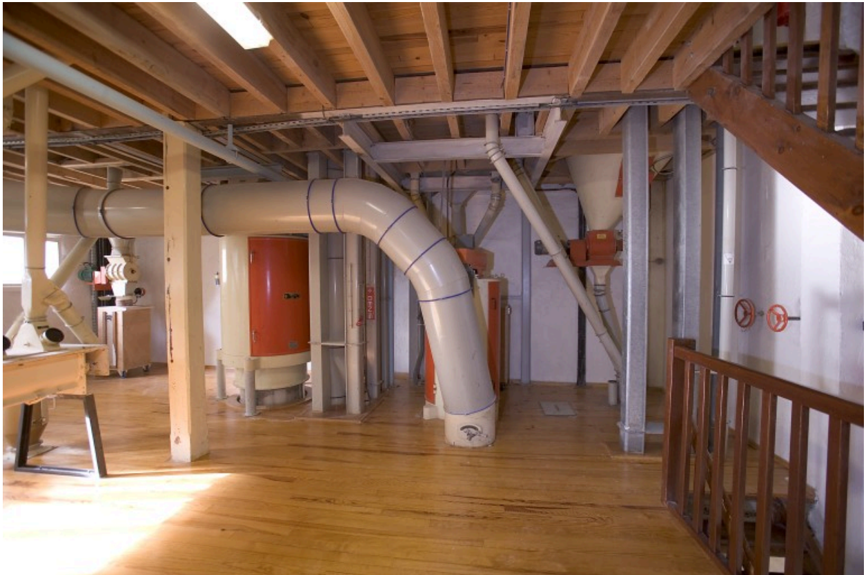
Minoterie, premier étage : la machine à broser le blé.
