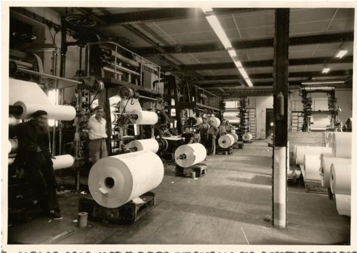
Vues de la papeterie de Bessé-sur-Braye au XXe siècle. l'atelier des calandres vu dans le 3e quart du XXe siècle.
