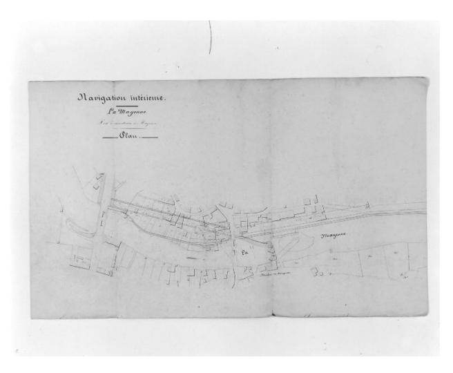
Projet de réalisation d'un quai et d'un port, rive gauche. Premier projet (non réalisé) de construction d'une écluse à sas à l'emplacement de l'ancienne chaussée.
