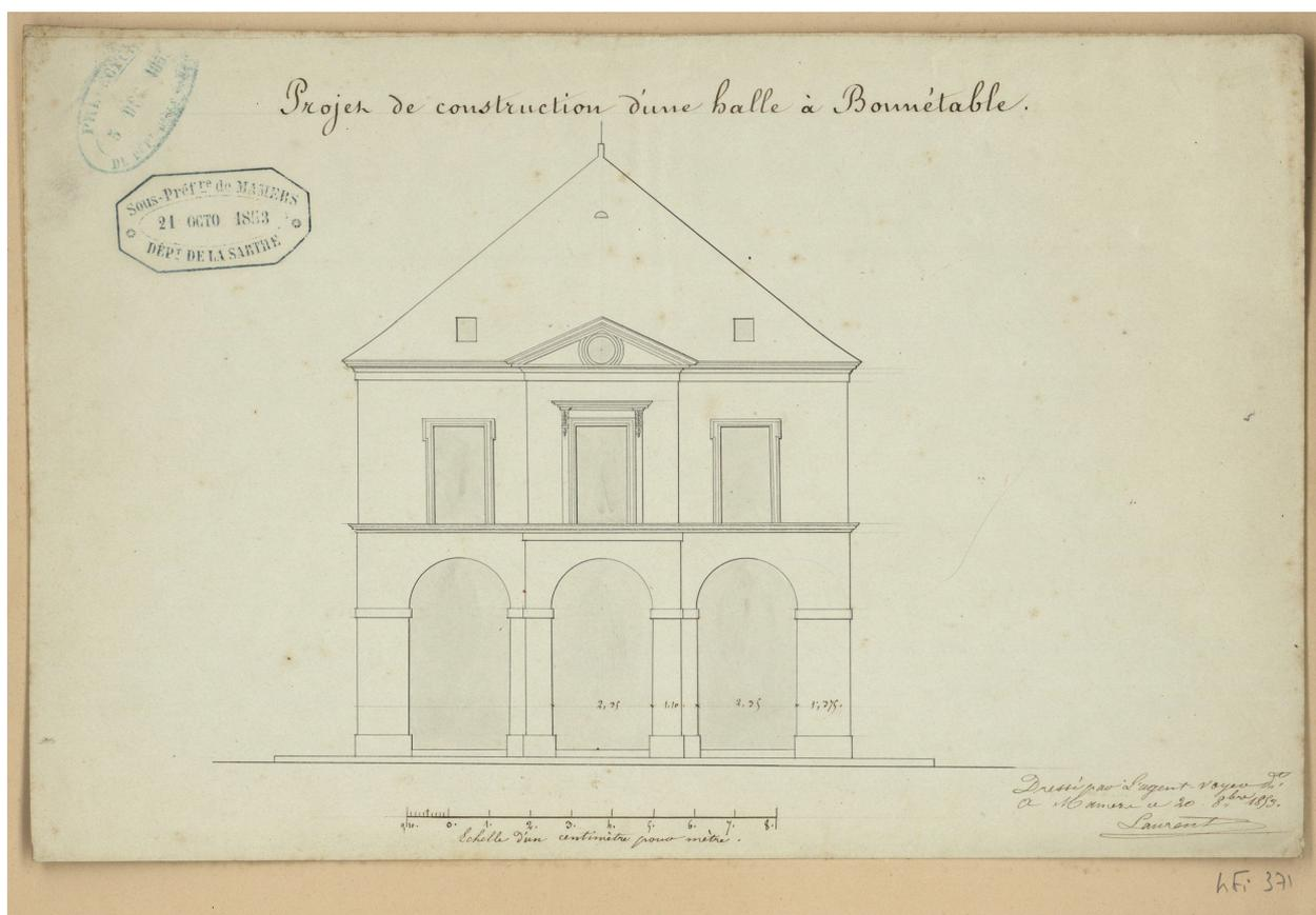
Projet de construction de 1853 : élévation des murs-pignons, avant suppression des avant-corps
