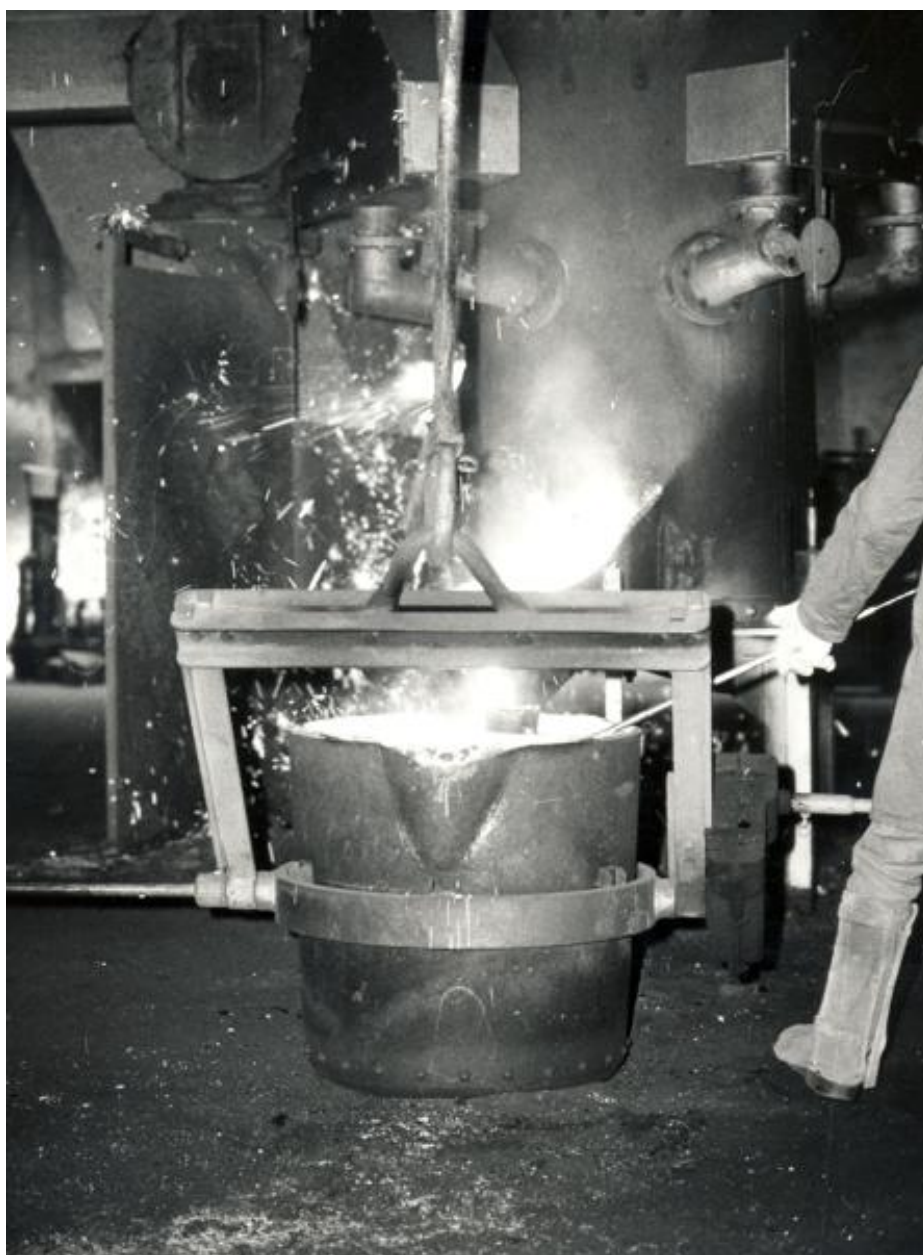
Atelier de fonderie : coulée de la fonte du cubilot dans le creuset.
