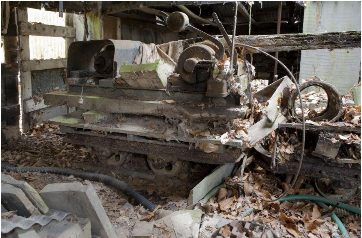
Ardoisière des Bompierres : machine à scier.
