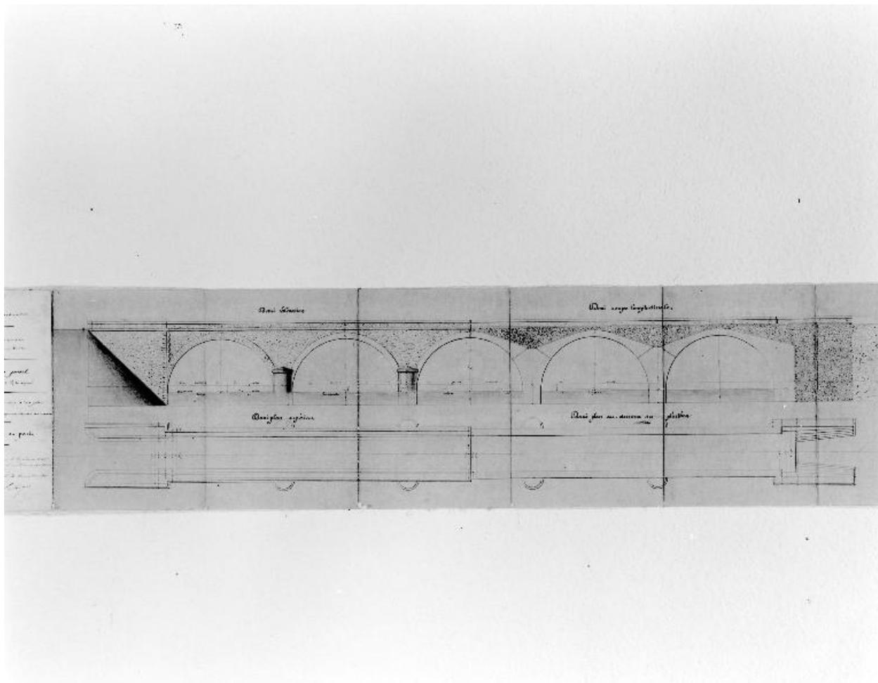
Projet réalisé. Demi-plans inférieurs et supérieurs, demi-coupe longitudinale et demi élévation.
