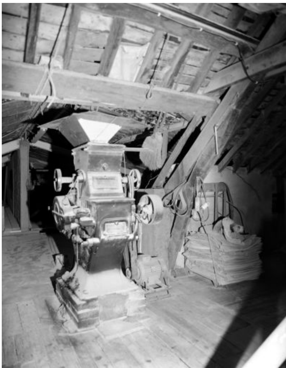
Comble. Aplatisseur d'orge.
