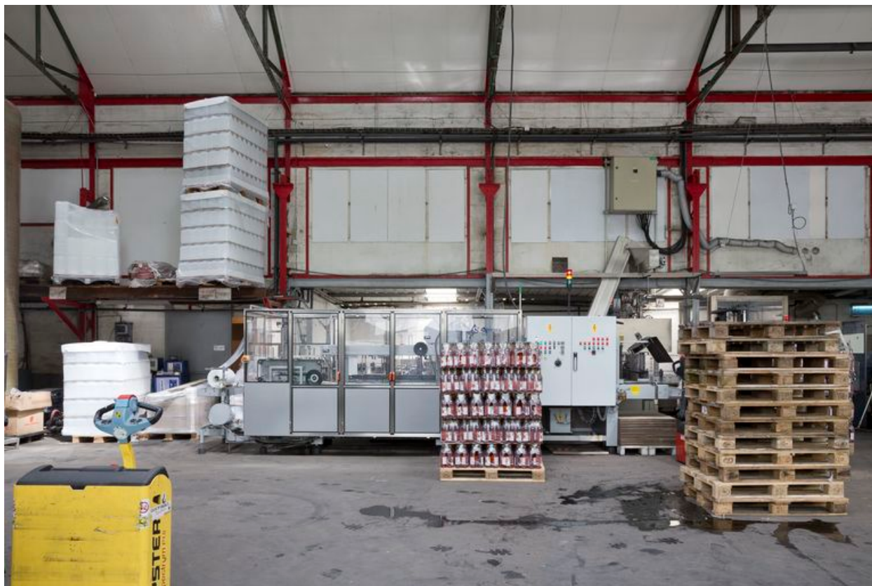
20 boulevard de Cardiff : Ligne verre, conditionnement des bouteilles.
