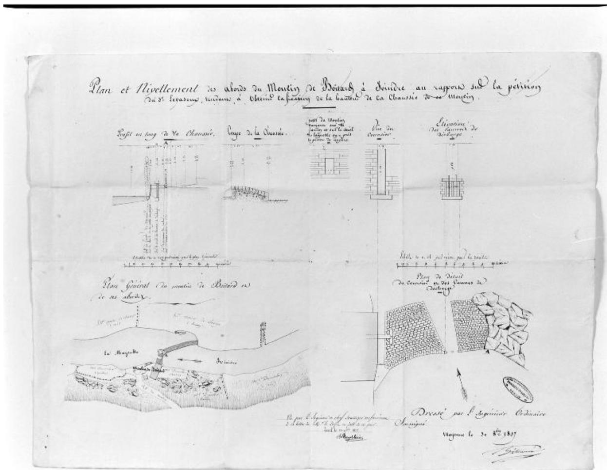
Plan d'ensemble et plan de détail du moulin et du barrage. Profil en long et coupe du barrage. Elévations du coursier et de la vanne de décharge. 1837.
