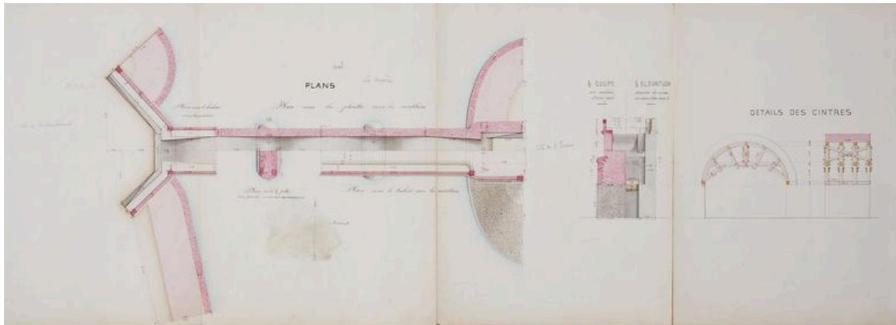
Projet de reconstruction du pont de Bel Abord, par E. Halgan, 1871 : plans, coupe et élévation d'une pile, détails des cintres.
