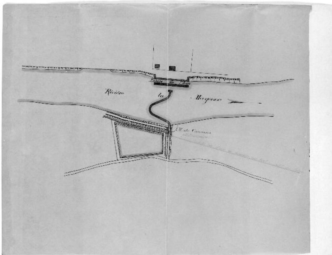
Plan d'ensemble du site : barrage, écluse, maison éclusière ; sur la rive droite : bassin aquicole (détruit) et pompe à eau (détruite) destinée à l'irrigation et à l'approvisionnement du château d'Orange.
