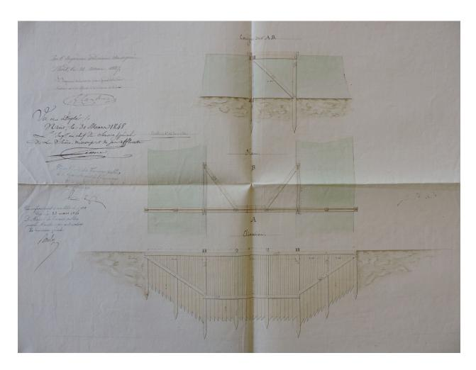
Projet de barrage mobile dans le port, dans le cadre du creusement du canal de Bourneau, 27 mai 1847 : coupe, plan et élévation.
