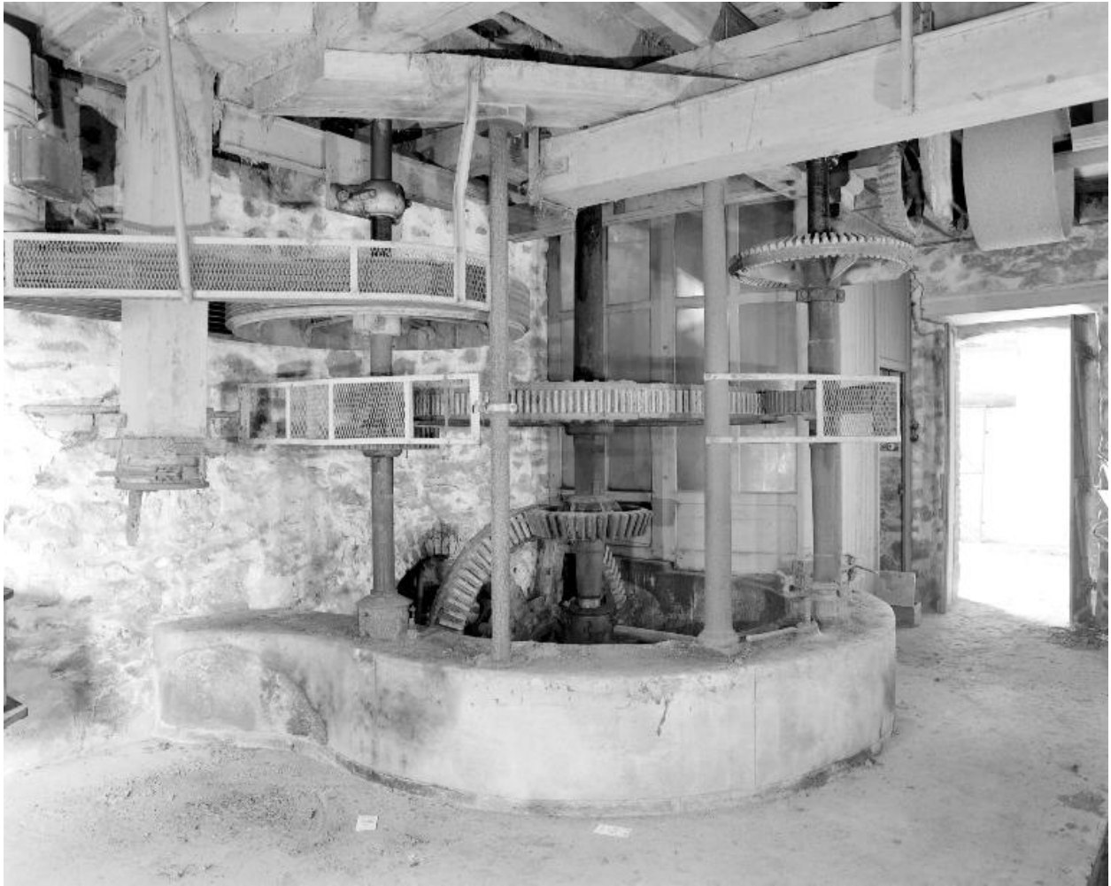
La poquerie, contenant le mécanisme de transmission.
