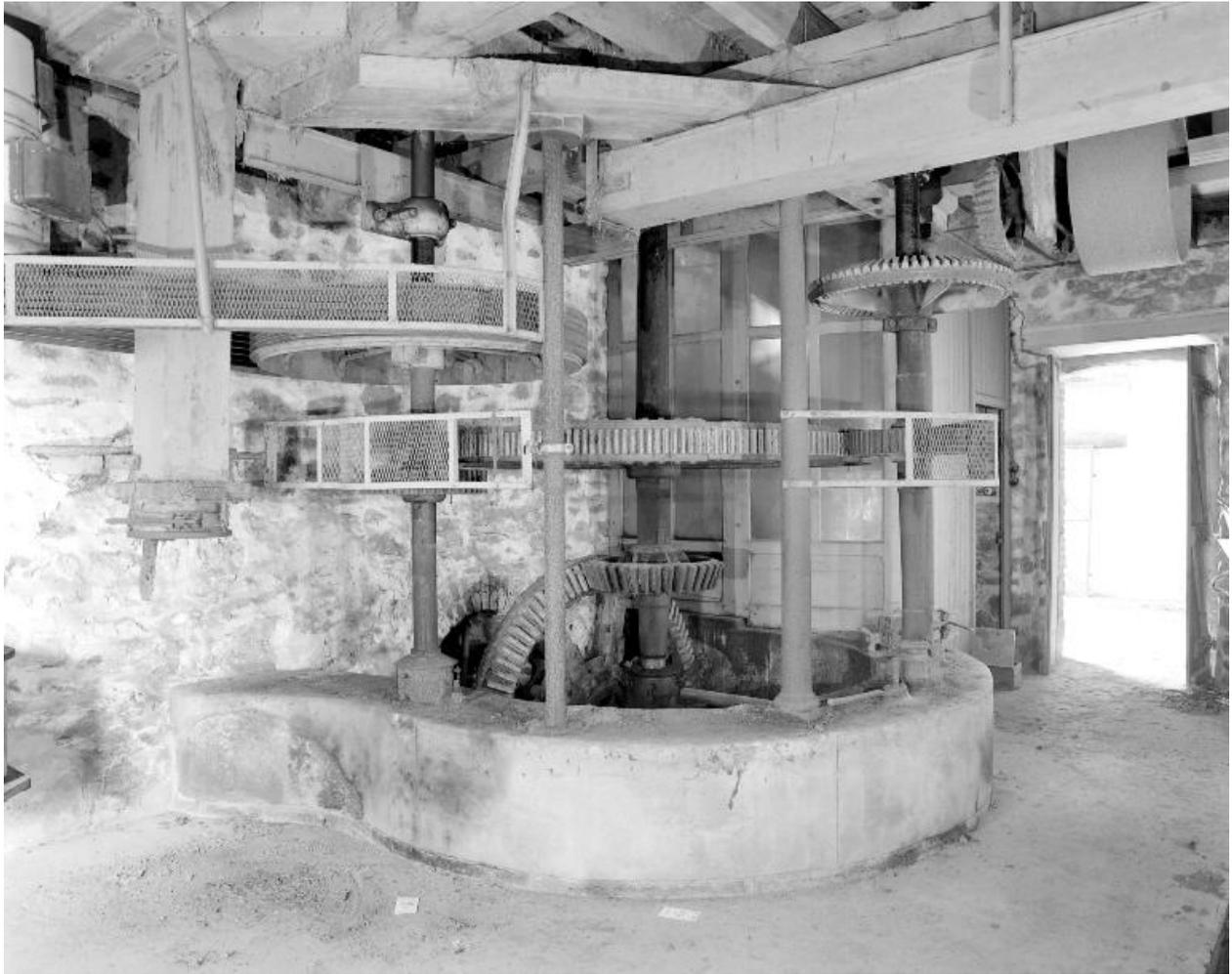
La poquerie, contenant le mécanisme de transmission.
