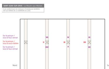
Plan de situation des marques d'assemblage repérées sur la charpente du logis.
