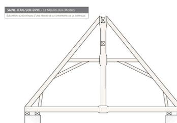
Elévation schématique d'une ferme de la charpente de la chapelle.
