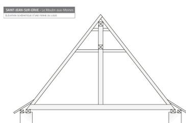
Elévation d'une ferme de la charpente du logis.
