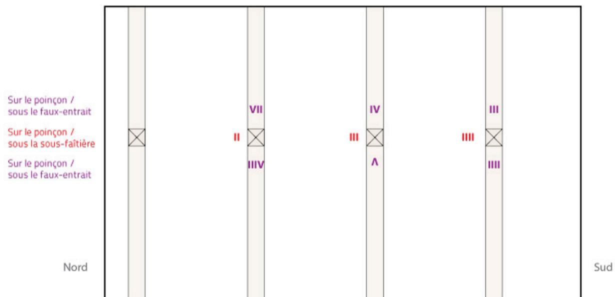
Plan de situation des marques d'assemblage repérées sur la charpente du logis.
