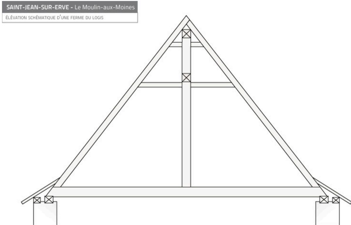
Elévation d'une ferme de la charpente du logis.
