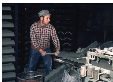
Enlèvement des tuiles en position de séchage, vers 1980. Phot. Christian Errath IVR52_20218501997NUCA
