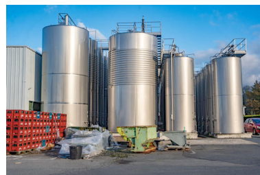
Cuves aériennes inox et leurs serpentins de refroidissement. Phot. Pierre-Bernard Fourny IVR52_20214401047NUCA
