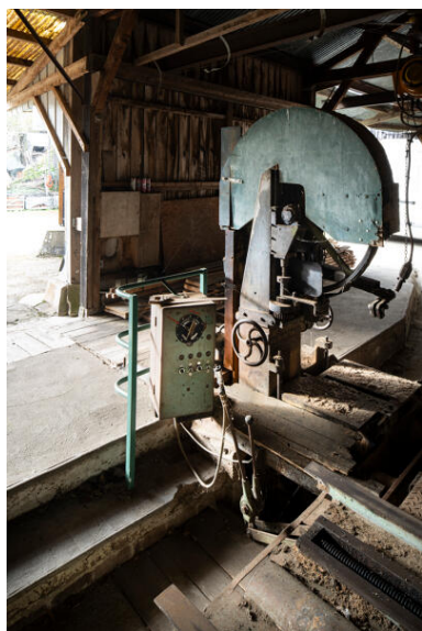
Machine de scie à ruban. Phot. Thierry Seldubuisson IVR52_20247200320NUCA
