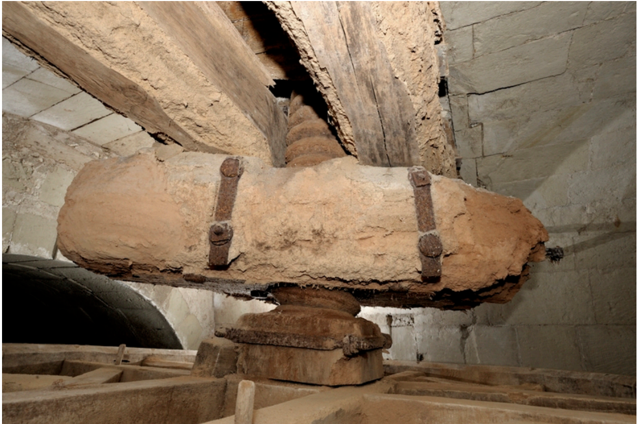
Pressoir : détail de la vis.
