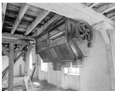
Deuxième étage, partie sud-ouest vue depuis le nord, en 2002 : bluterie-diviseur pour le remoulage. Phot. François Lasa IVR52_20025300728X
