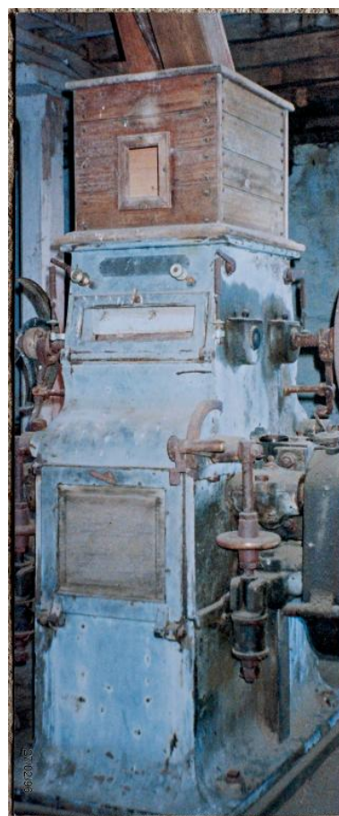
Premier étage, partie sud-ouest, en 2004 : broyeur à cylindres. Autr. Charlotte Moriarty, Repro. Yves Guillotin IVR52_20195300309NUCA
