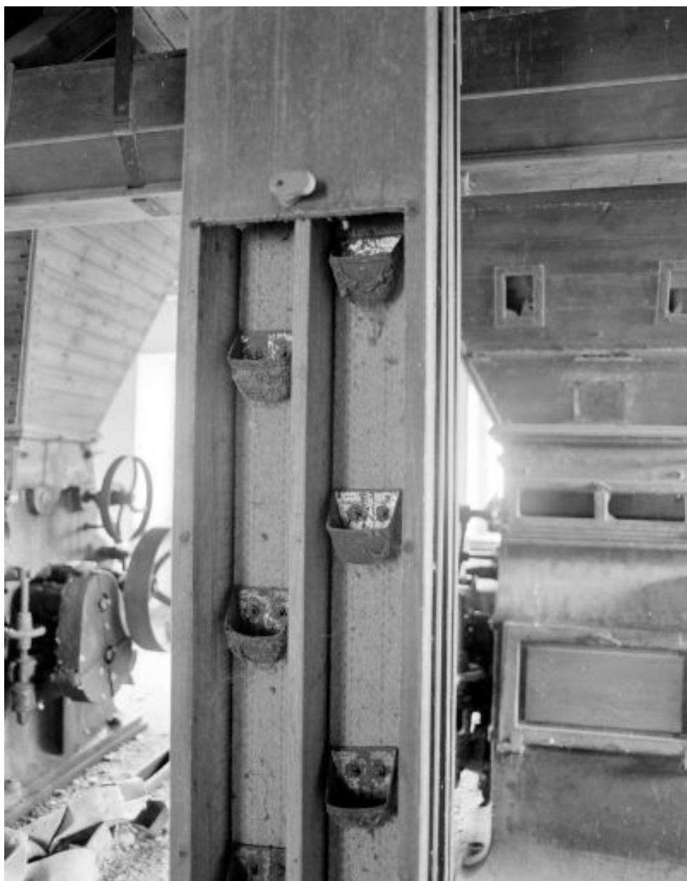
Premier étage, en 2002 : élévateur à godets.
