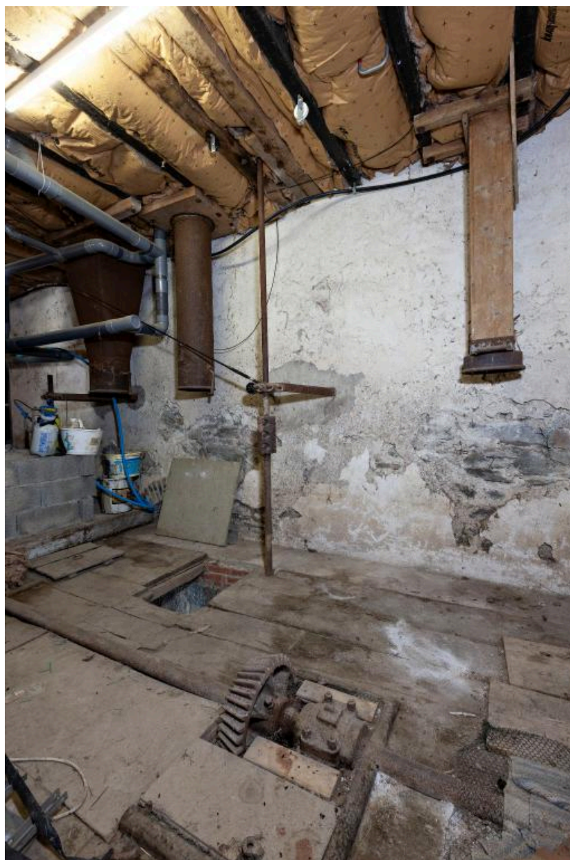
Rez-de-chaussée, partie est, en 2019 : ensacheurs à farine de blé, à son et à céréales secondaires situés presque au-dessus des turbines.
