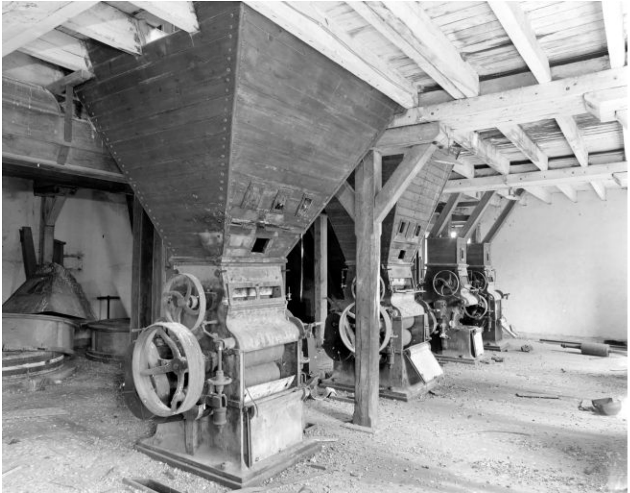
Premier étage, partie sud-ouest, en 2002 : les convertisseurs et les broyeurs à cylindres.
