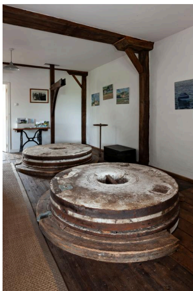
Premier étage, partie nord vue depuis le sud-est, en 2019 : les deux paires de meules et la potence. Phot. Yves Guillotin IVR52_20195300308NUCA
