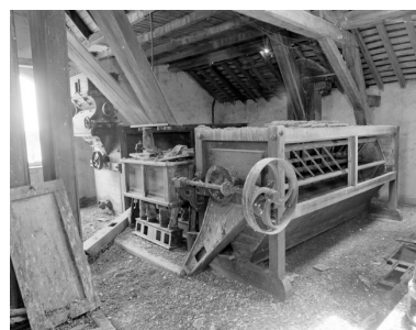
Comble, partie sud, en 2002 : bluterie à pans et plansichter. Phot. François Lasa IVR52_20025300727X
