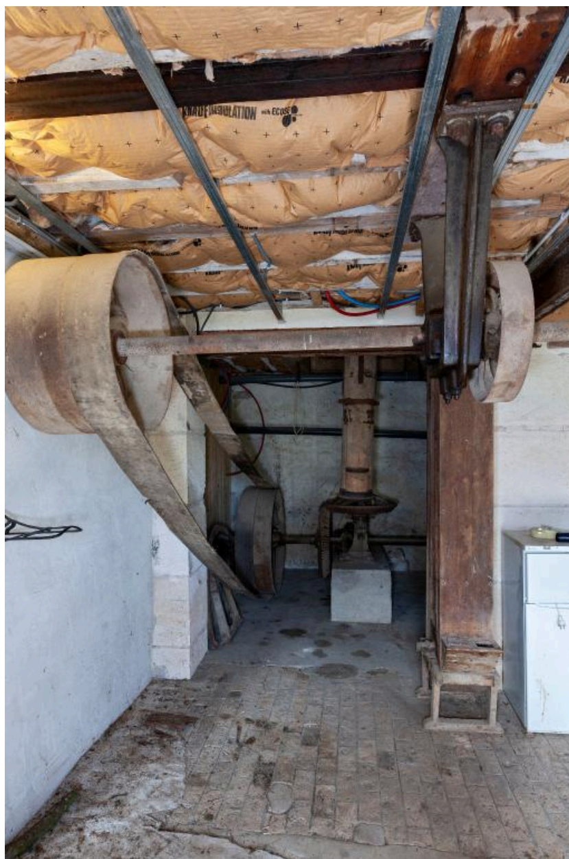
Rez-de-chaussée, partie nord-ouest vue depuis le sud-ouest, en 2019 : mécanisme de transmission de la force motrice aux meules ; ensacheur à céréales secondaires recevant la mouture de l'une des paires de meules.
