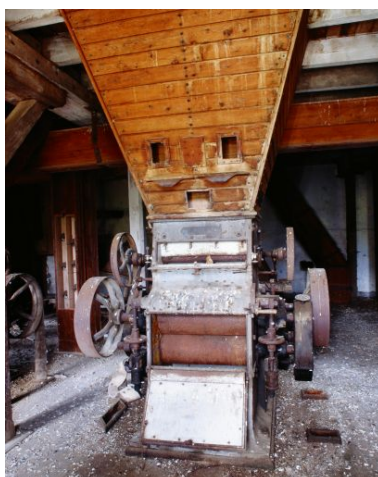
Premier étage, partie sud-ouest, en 2002 : deuxième convertisseur à cylindres. Phot. François Lasa IVR52_20025300751XA
