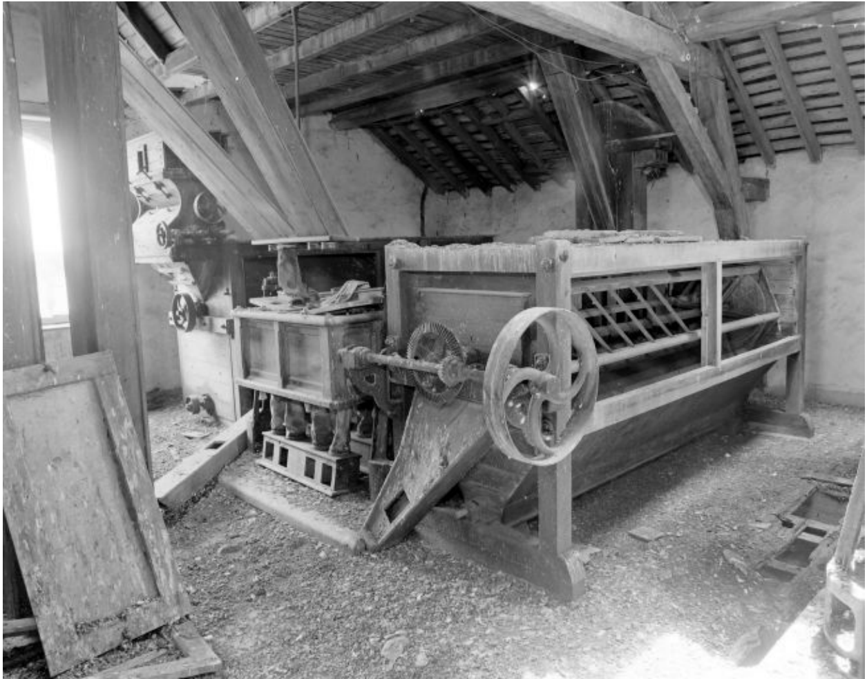
Comble, partie sud, en 2002 : bluterie à pans et plansichter.
