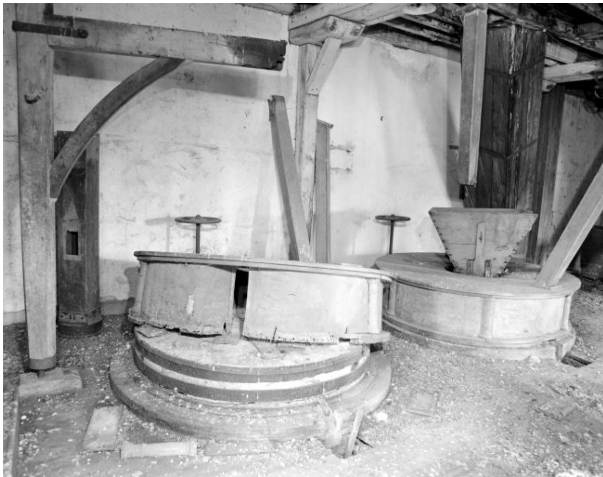
Premier étage, partie nord vue depuis l'ouest, en 2002 : les deux paires de meules et leur archure. A gauche, la potence servant à soulever les meules avant leur rhabillage. Sur les meules de droite est posée une trémie.
