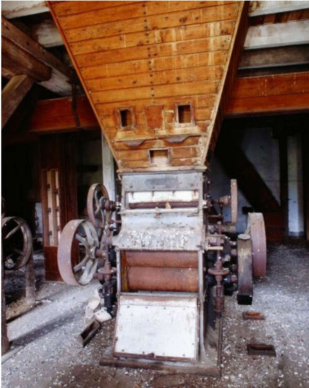
Premier étage, partie sud-ouest, en 2002 : deuxième convertisseur à cylindres.
