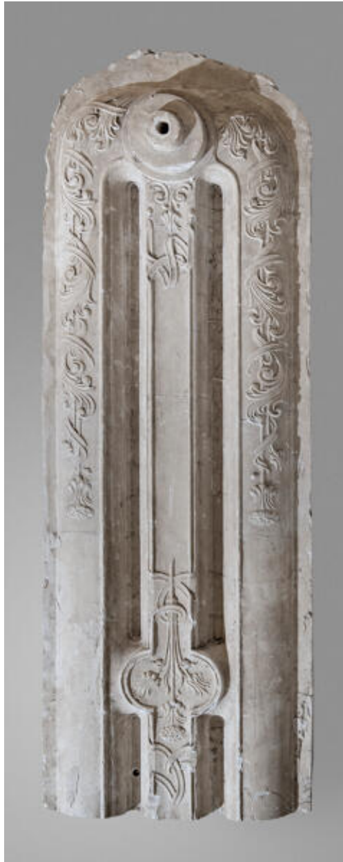
Moulage en plâtre d'un radiateur réalisé par l'atelier Cottureau pour la fonderie Chappée.
