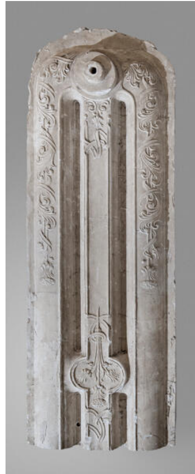
Moulage en plâtre d'un radiateur réalisé par l'atelier Cottureau pour la fonderie Chappée. Phot. Thierry Seldubuisson IVR52_20237200291NUCA
