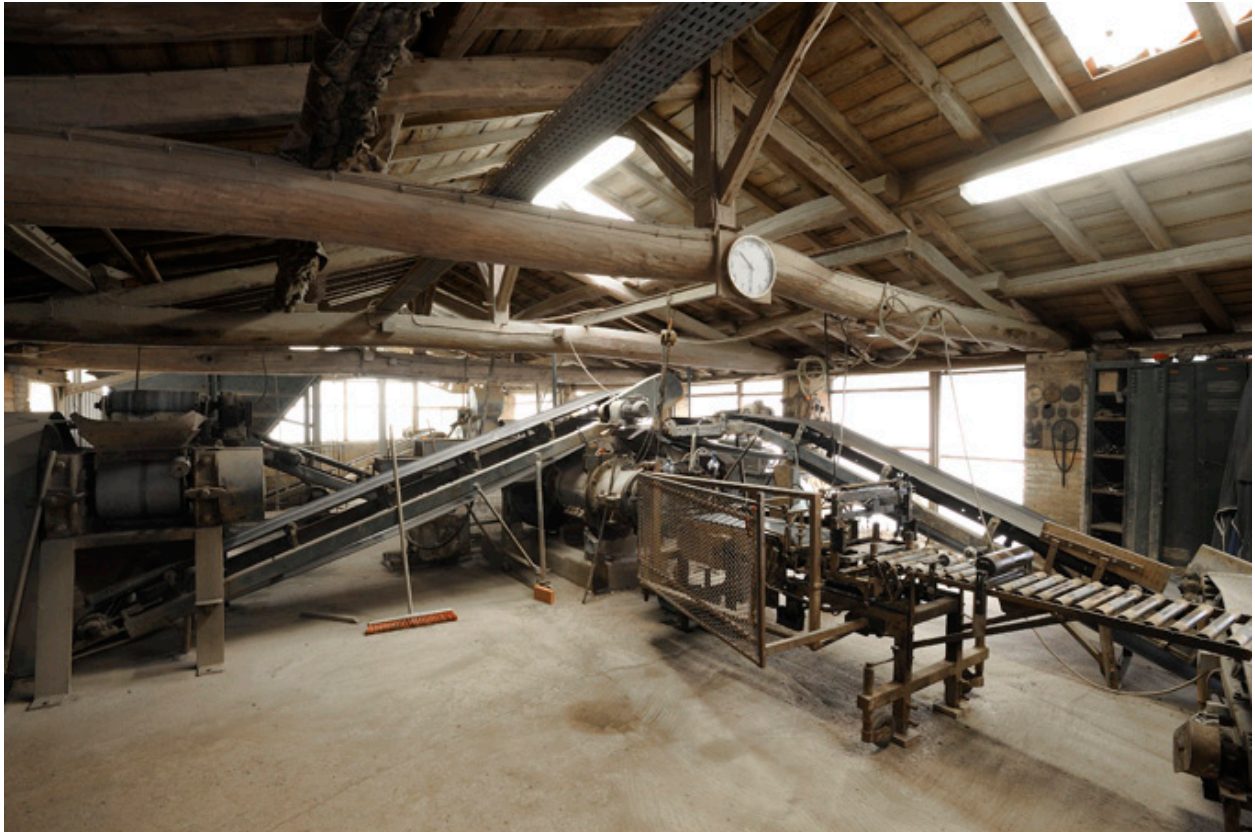
Chaîne de production des tuiles ou briques, du broyeur à la matrice.
