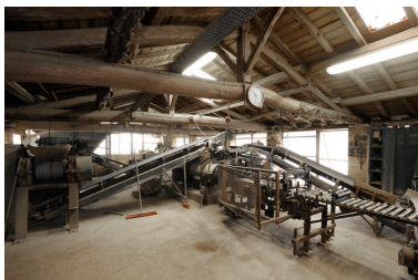
Chaîne de production des tuiles ou briques, du broyeur à la matrice. Phot. Bruno Rousseau IVR52_20114900312NUCA
