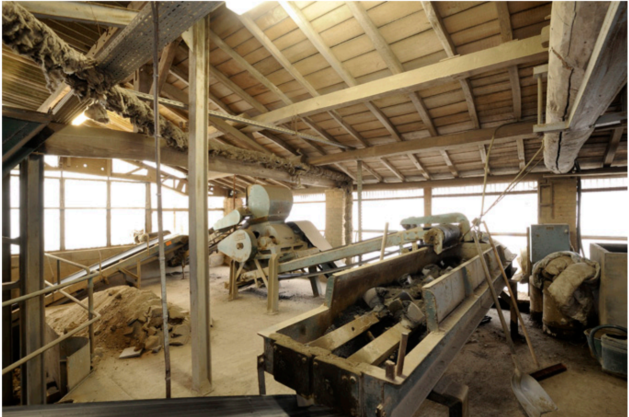
Deux broyeurs permettant de transformer l'argile en grosse mouture, puis de l'affiner.
