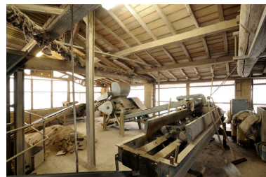
Deux broyeurs permettant de transformer l'argile en grosse mouture, puis de l'affiner. Phot. Bruno Rousseau IVR52_20114900313NUCA
