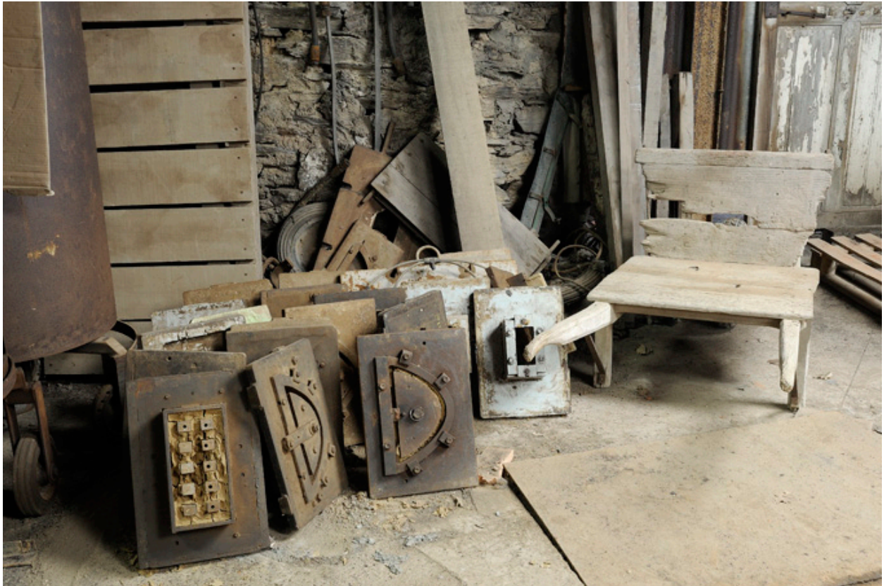
Plusieurs matrices, utilisées pour donner la forme aux différentes tuiles et briques.
