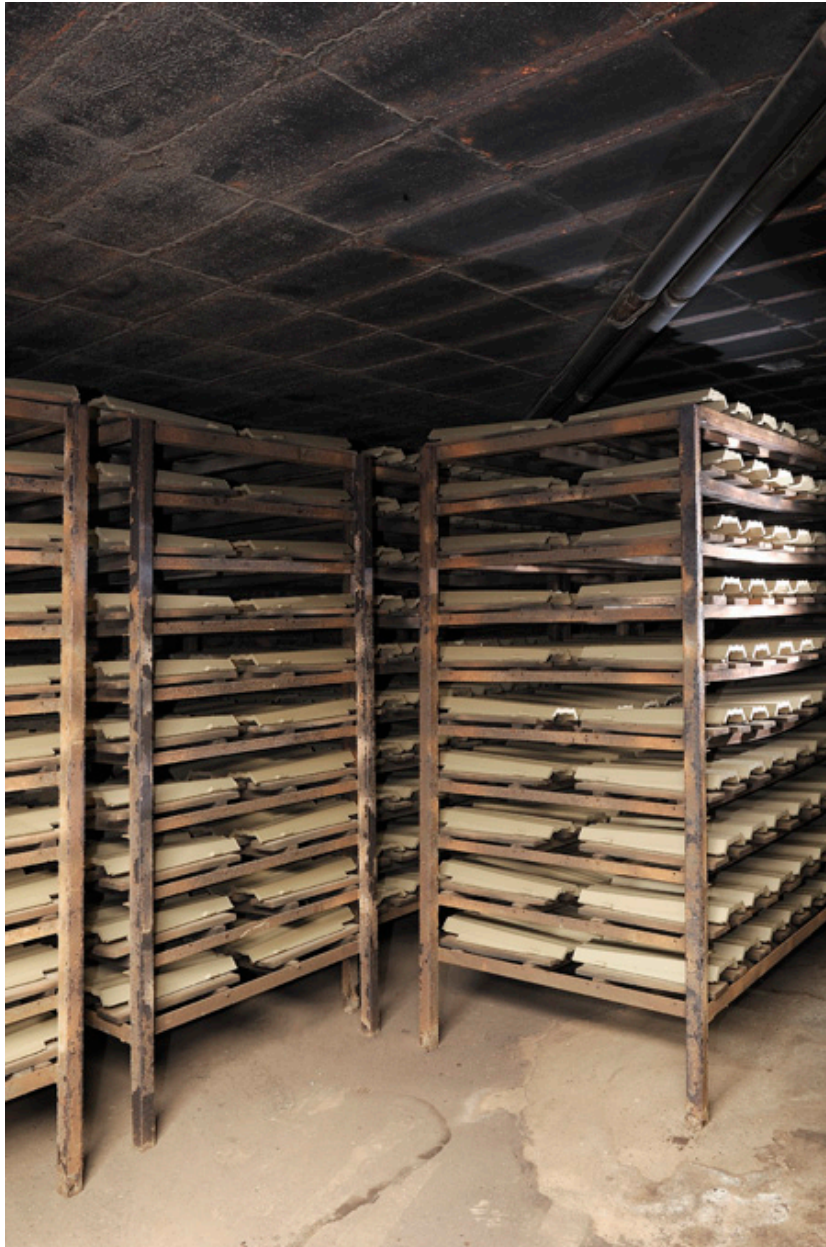
Le séchoir, salle qui reçoit l'air chaud du four pendant la cuisson.
