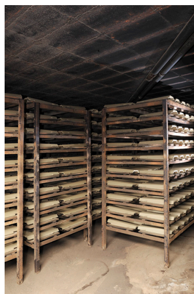
Le séchoir, salle qui reçoit l'air chaud du four pendant la cuisson. Phot. Bruno Rousseau IVR52_20114900329NUCA
