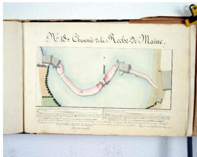
Planche N° 18 du recueil des plans des barrages de la partie navigable de la Mayenne. Plan d'ensemble du site de la Roche avant la construction de l'écluse : barrage, porte marinière, moulins à farine.
