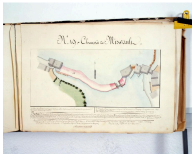
Planche N° 19 du recueil des plans des barrages de la partie navigable de la Mayenne. Plan d'ensemble du site de Mirvault avant la construction de l'écluse : barrage, porte marinière, moulins à farine de Goupileau, de Fontenailles et de Mirvault (rive droite), moulin à farine de la Chesnaye (rive gauche). Autr. Louis-Xavier Deslandes de Lancelot, Repro. François Lasa IVR52_20015300190XA
