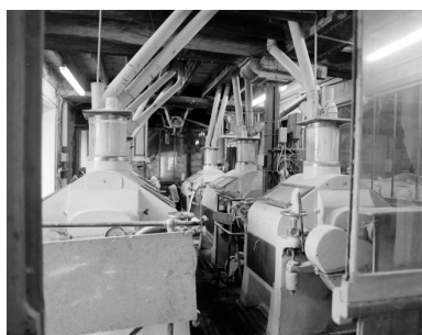
Premier étage. Les broyeurs à cylindres, vus du nord-est. Phot. François Lasa IVR52_20025300778X
